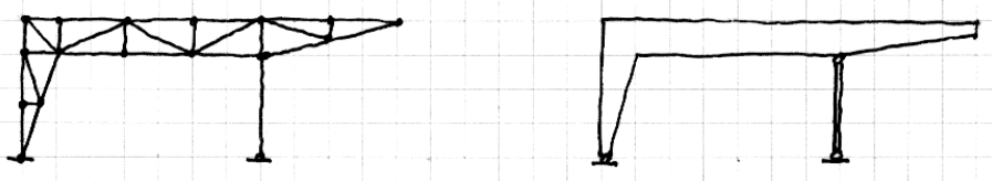
Figur 2: Gitter og ramme, to typer konstruktive systemer der består af henholdsvis stænger og bjælker. Ofte betragtes de imidlertid som to typer konstruktive elementer.
