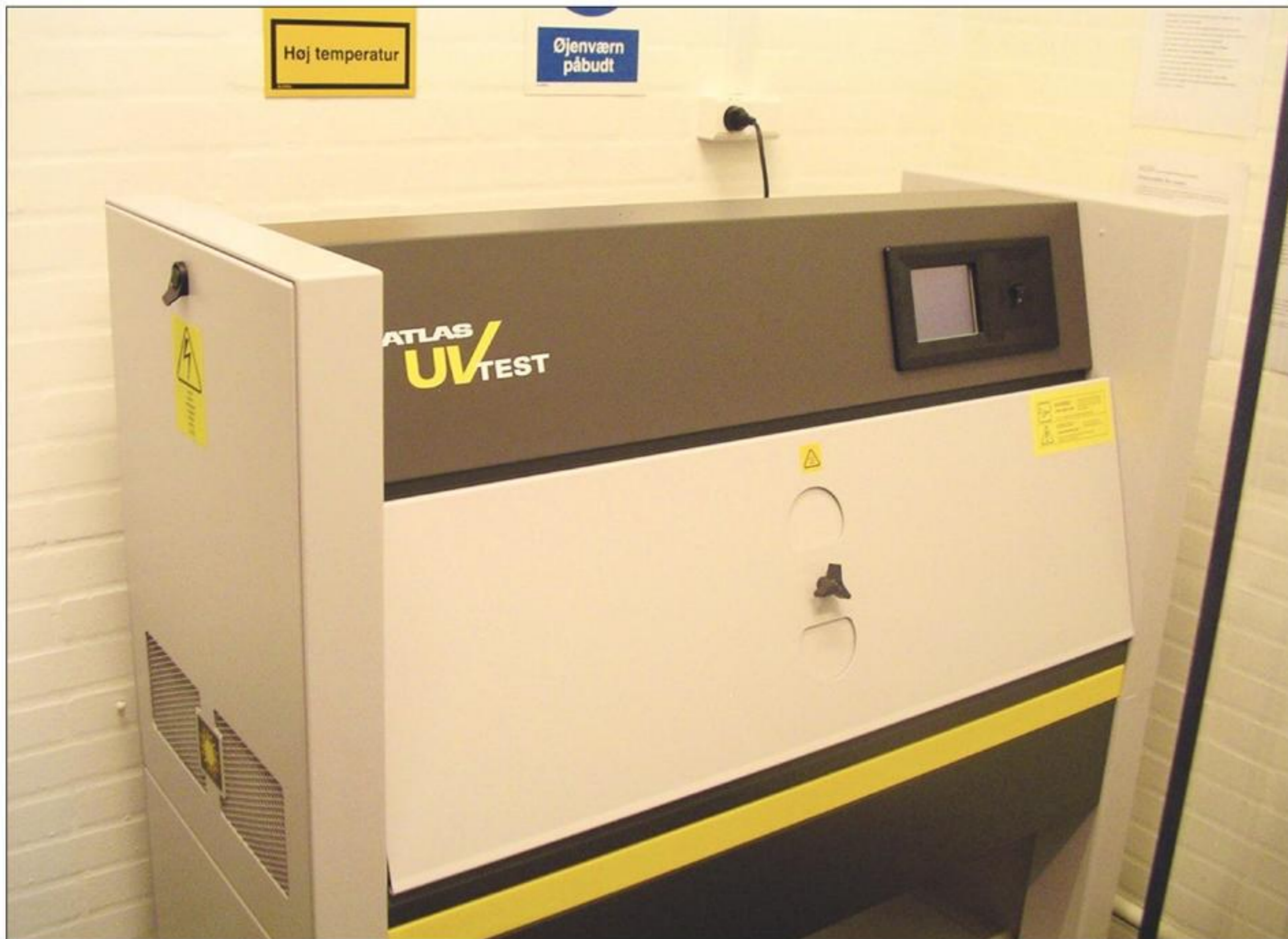
Figur 2. Ultraviolet lyseksponeeringsapparat på DTU-Chemical Engineering med mulighed for periodevis kunstig regn. Malingsprøverne er placeret bag den skrå grå plade og en række lysstofrør sørger for belysningen. Apparatet er udviklet af Atlas-koncernen og købt hos danske Strenometer A/S.
