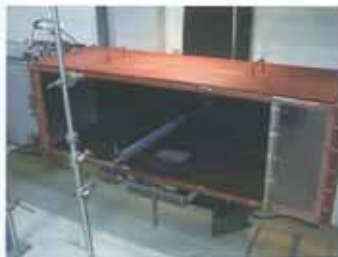
Vindtunnelens testsektion med opsætning af flow visualisering. Foto: Jakob Strømmand-Andersen
