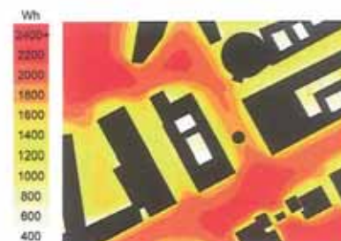
Simulering af direkte og diffus solstråling på Axeltorv, KBH (Wh, daglige gennemsnitsværdier). Illustration: Jakob Strømmand-Andersen
