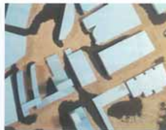
Erstatning af bymiljø i vindtunnelen (Aalborg, KBV) Illustration: Jakob Strømmand-Andersen
