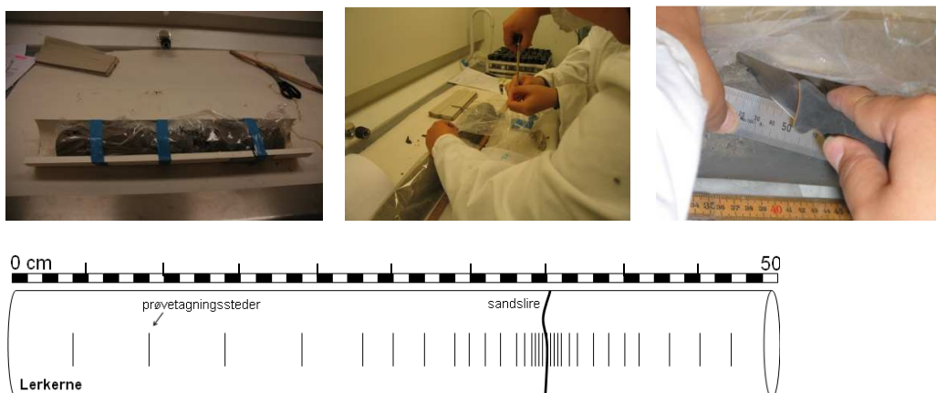
Figur 5: Prøveudtagning i laboratoriet. Skitseeksempel på kerne med sandsliire og herudfra bestemte prøvetagningssteder er illustreret nederst .
