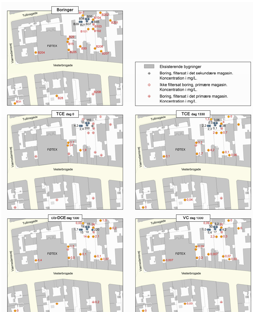
Figur 7: TCE koncentrationer før afværge (dag 0) og af TCE, cis-DCE samt VC 3,5 år efter afværge (dag 1330).
