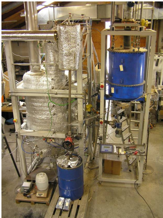
Figur 5: 100 kW LT-CFB forgasser på DTU, med brændselsindfødningsilo (blå øvre) og asketønde (blå nedre) - set fra 1. sal i forsøgshallens nordlige ende.
