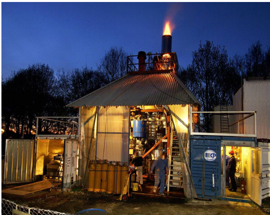
Figur 3: 500 kW LT-CFB anlægget på DTU (I skibscontainerne til venstre og højre er henholdsvis brændselslager og kontrolrum)
