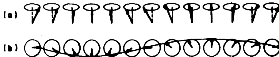
Fig. 3.2.1 En magnon på en række spin, (a) set i perspektiv, (b) set ovenfra; den viste længde er en bølgelængde (Kittel)
