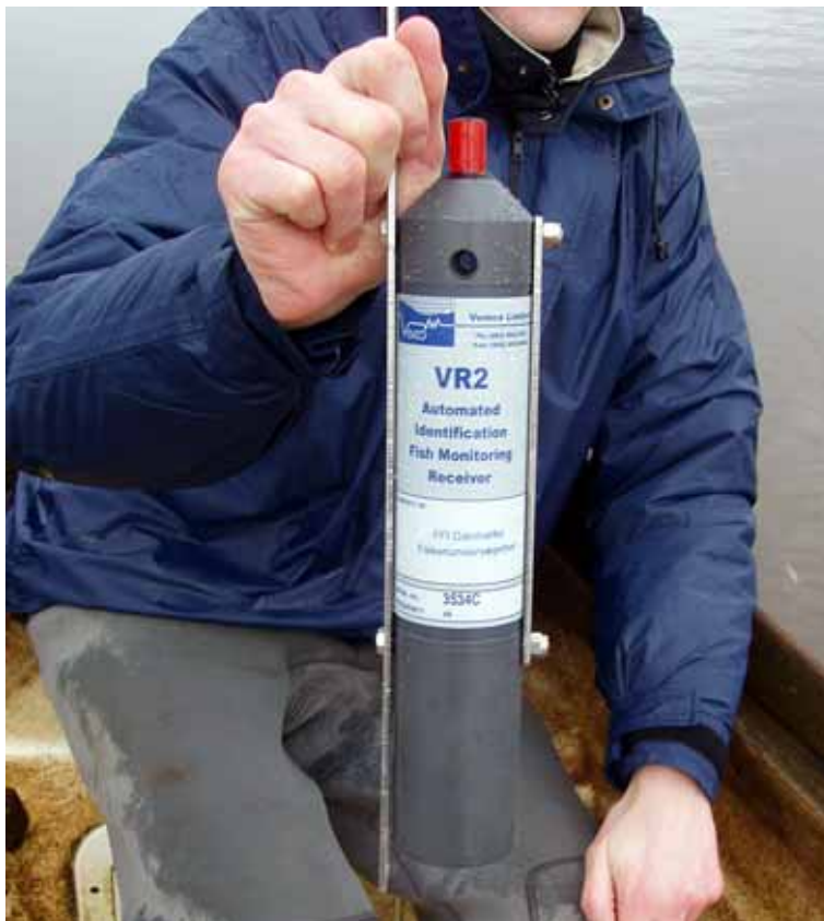
Figur 5. Akustik datalogger, som monteres hængende i et tov under en bølge med anker, eller hænges direkte på et bolværk. (Foto: Michael Deacon).
