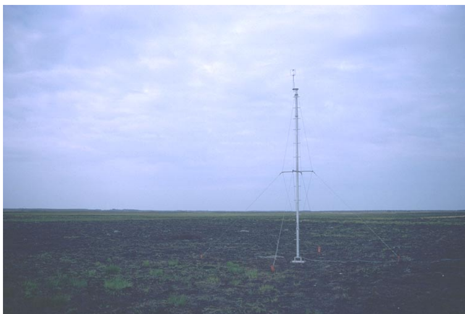
Figur 3-1. In-situ mikro-meteorologiske målinger af vind og turbulens: Sonicanemometer i top af 7-meter met-mast magen til den der blev anvendt ved Roager eksperimenterne 1999 og 2000.
