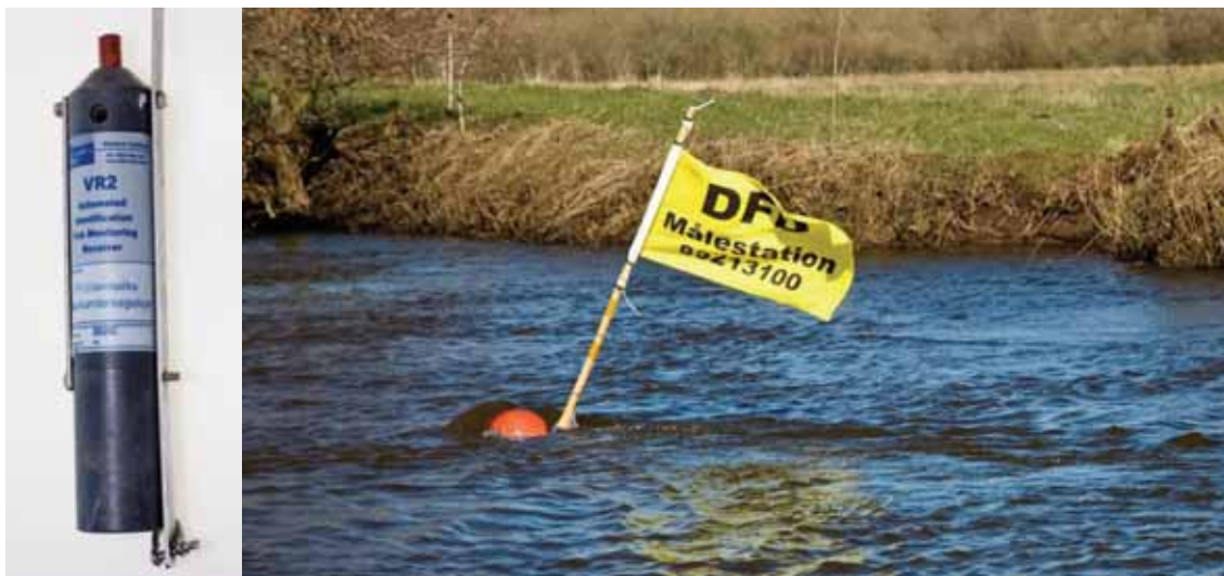
Figur 5. Akustisk datalogger. Loggerne var monteret under en forankret bøjle (t.h.) eller direkte på bolværk. Fotos: H. Baktoft.
