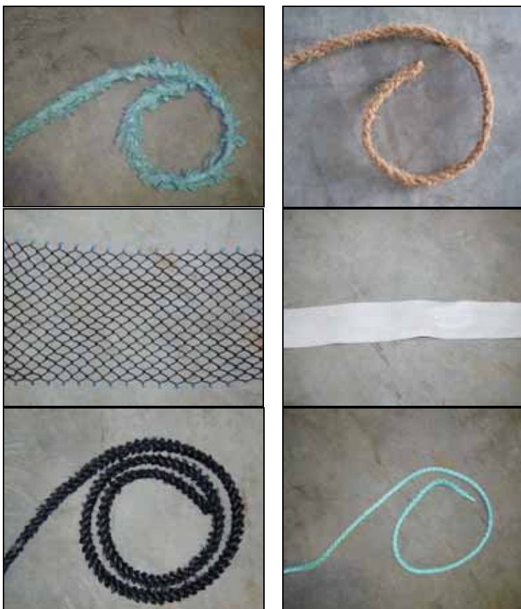
Figur 15. Et udvalg af forskellige medier. Øverst til venstre og ned Aqua Loop, not line og Fuzzy rope. Øverst til højre og ned kokos, bændler og Selstad.
