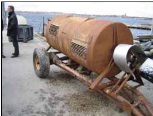
Figur 16. Maskine udviklet til bøjerensning (til venstre). Bøjer klar til at blive rensede i bøjerensningsmaskinen (til højre).
