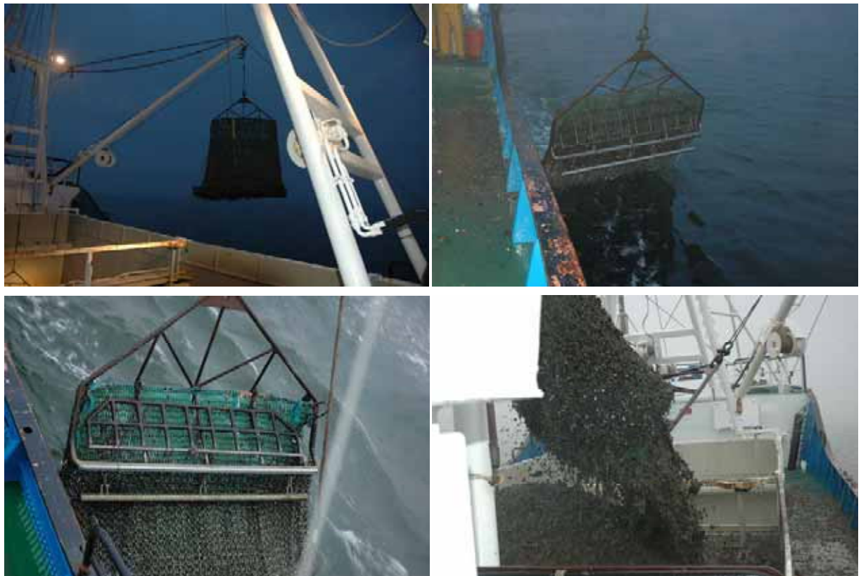
Figur 5.1. Skraberne, der anvendes på LIMFJORDEN ved fiskeri af omplantningsblåmuslinger (foto: P.S. Kristensen).
