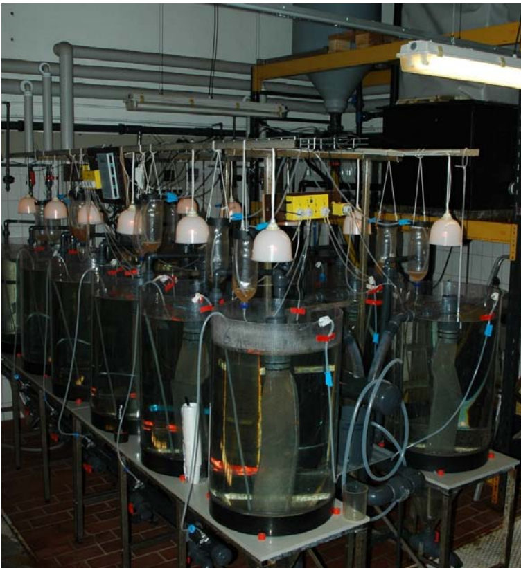
Figur 2B-4. Larveanlægget under startfodringen. Flaskerne, som hænger over karrene med rød væske i, er Artemia fodersystemet. De gule kasser er de peristaltiske pumper, som docerer Artemia ud i karrene. Centralt i karrene ses udløbsfiltrene (400 \mu\text{m} i de første dage) derefter 600 \mu\text{m} )
