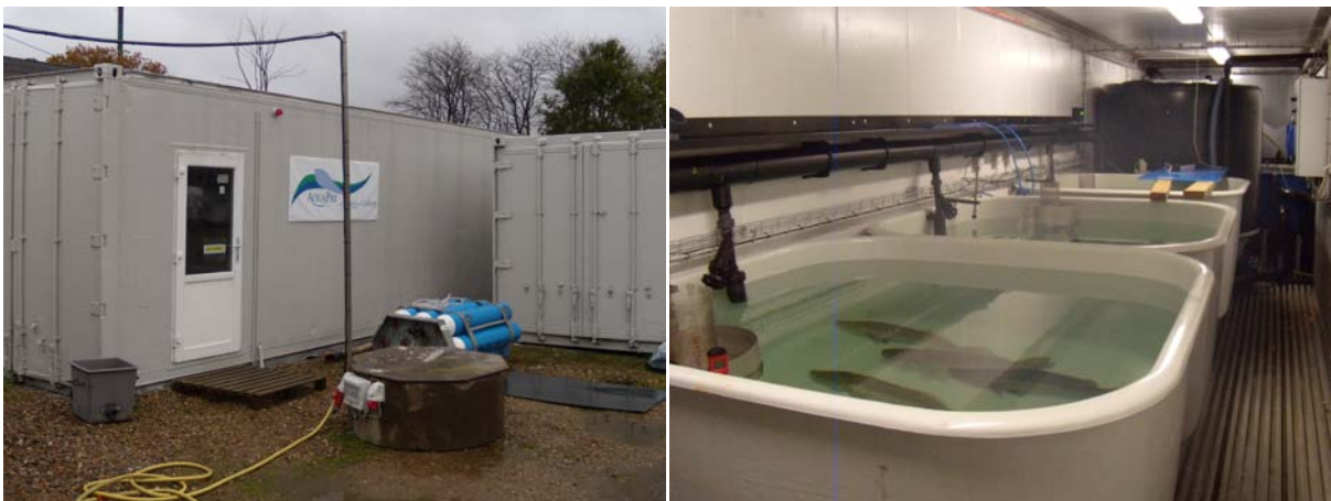
Figur 5-1. Moderfiskeanlæg indrettet i 40 fods container.
