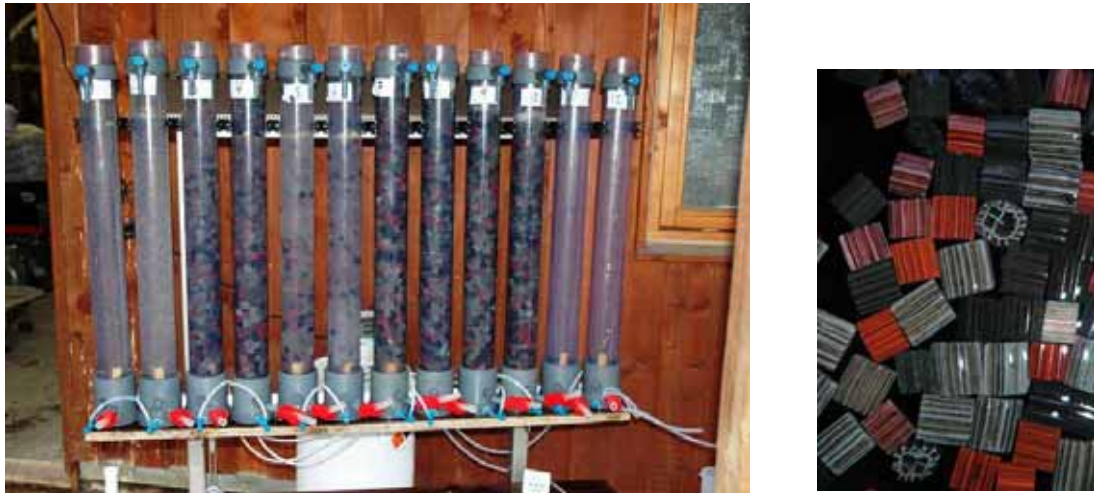
Fig. 7.4.1. Forsøgsopstilling med reaktorrør og bioelementer (t.h.) fra et model 3 dambrug.
