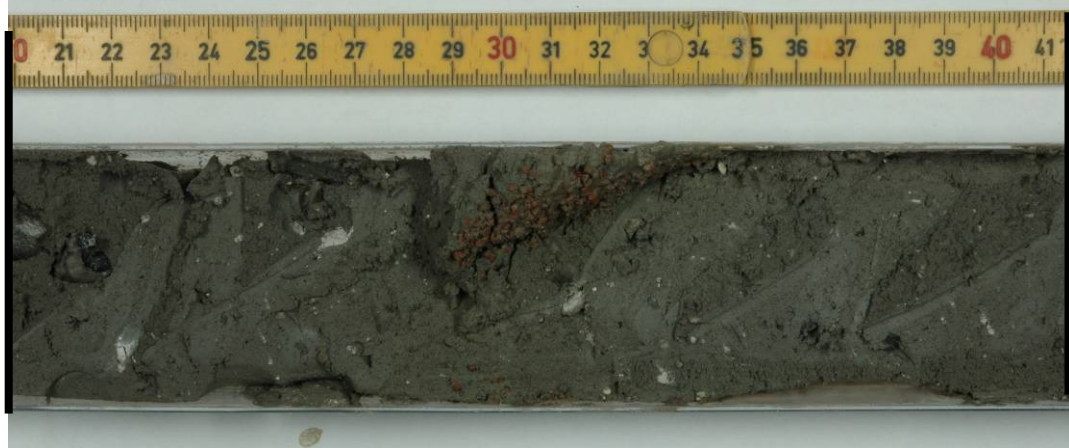
Hydraulisk fraktur i 6,5 m u.t. HF-K7
