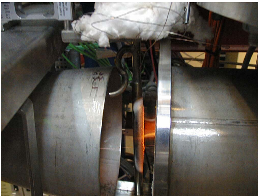
Figur 2 Forsøgsopstilling med belægningsproben placeret centralt. Til højre ses spalteåbningen fra faststofreaktoren. En flamme rammer den askebelagte probe.
