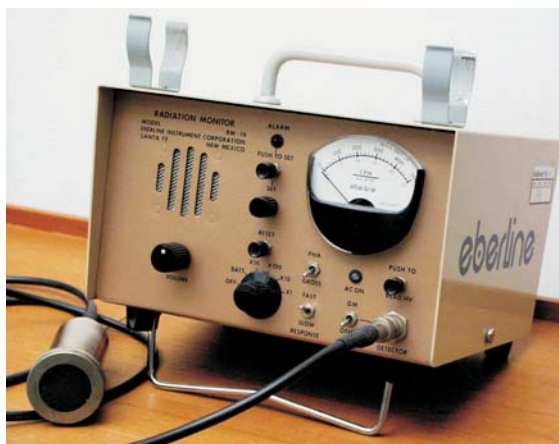
Figur 18. Kontaminationsmonitor. Proben med GM-detektoren ses fra vinduessiden, hvor vinduet er beskyttet med et trådnæt. Skalaen angiver "CPM" (counts per minute).
