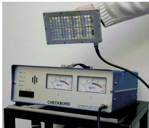
Figur 17. Bordmonitor. Proben (proportionaldetektoren) ses fra vinduessiden, hvor vinduet er beskyttet med et trådnæt. Monitoren har to viserinstrumenter til visning af henholdsvis \alpha - og \beta -aktivitet. Skalaerne angiver overfladekontaminationsniveauerne i Bq/m^2 .
