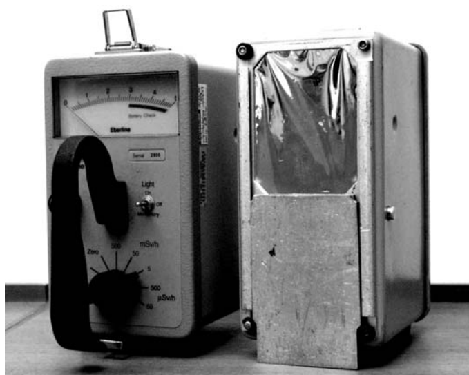
Figur 15. Ionkammer til måling af dosishastighed. På kassens underside er der en skærm af 5 mm aluminium, der dækker et tyndt folievindue; uden skærmen for vinduet vil også \beta -stråling blive detekteret. Skalaens visning kan indstilles med en omskifter. På det viste instrument svarer fuldt udslag i det mest følsomme område til 50 \mu\text{Sv/h} .
