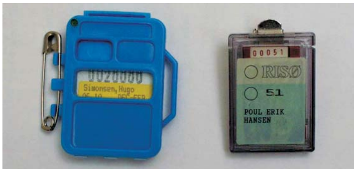
Figur 21. Persondosimetre. Til venstre: et film dosimeter, som det anvendes af SIS (Statens Institut for Strålehygiejne) og til højre: et TL-dosimeter, som det bruges på Risø.
