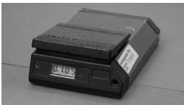
Figur 22. Elektronisk lommedosimeter med digital udlæsning. Dosisregistreringen sker ved ionisering i et lille GM-rør. Det viste dosimeter har modtaget en dosis på 0,105 mSv
