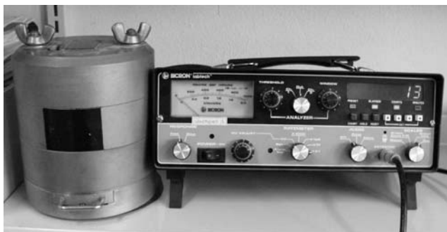
Figur 19. Opstilling til måling af aktivitet i aftøringsprøver, luftprøver eller inddampede prøver. Detektoren er en GM-detektor, som er afskærmet med jern. Filterpapiret anbringes i en skuffe nederst. Instrumentet (scaleren) til højre akkumulerer tællingerne, men kan også vise tællinger pr. tidsenhed.
