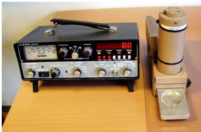
Figur 4. \alpha -tællehus med en ZnS-scintillationsdetektor tilsluttet en scaler.
