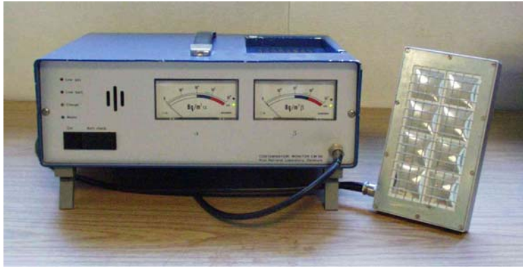
Figur 5. Kontaminationsmonitor CM 86 med proportionaldetektor der muliggør en samtidig måling af \alpha - og \beta -overfladekontamination.
