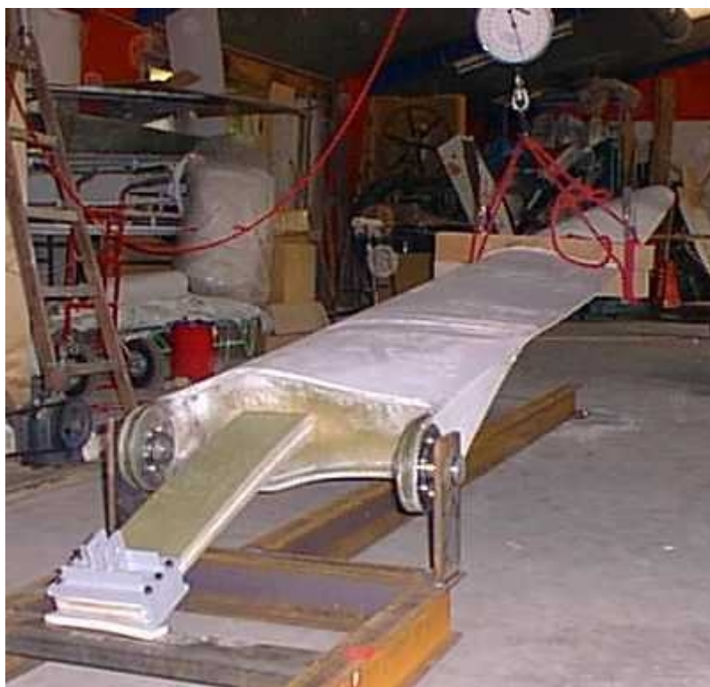
Figur A-1 Vinge og flex-beam i prøvestand hos Olsen Wings.
