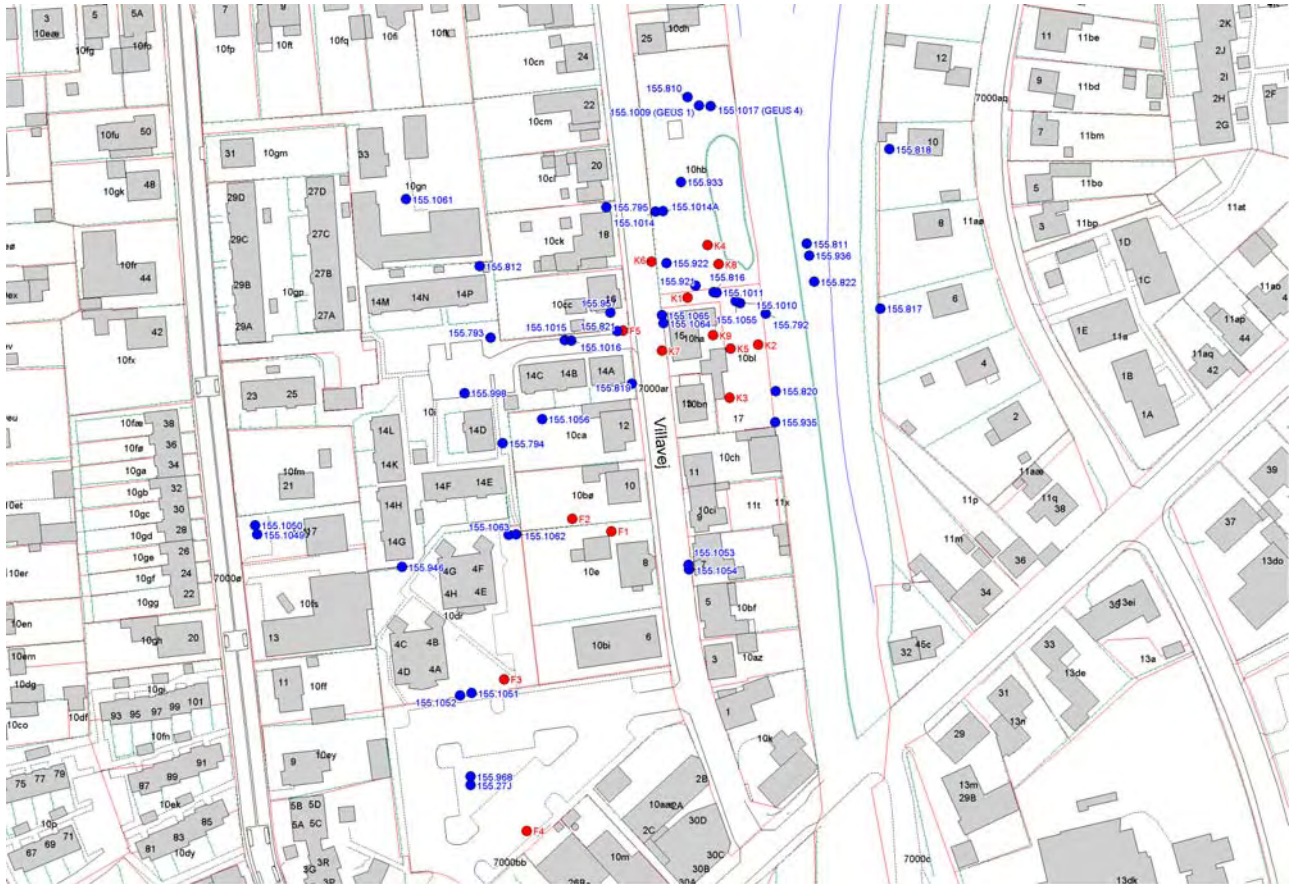
Figur 4.1. Beliggenhed af boringer ved og nedstrøms RTA. De nye boringer (K1-9 og F1-5) er markeret med rød signatur. Samhørende boringsnummer og DGU nummer fremgår af bilag 1.3.
