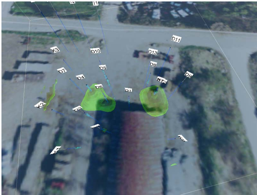
Figur 4 Screenshot fra en 3D model opbygget ud fra MIP sonderingerne. De grønne volumener indikerer de værst forurenede områder, fra /6/.
