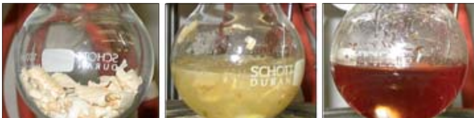
Figur 3. Opløsning af træspåner i den ioniske væske 1-butyl-3-methylimidazolium chlorid, [BMIM]Cl, ved opvarmning til 110°C. Billederne er taget inden der tilsættes ionisk væske (venstre), efter 1 times reaktion (midten) og efter 5 timers reaktion (højre). Foto: Peter Schultz (Universität Erlangen-Nürnberg, Tyskland).
