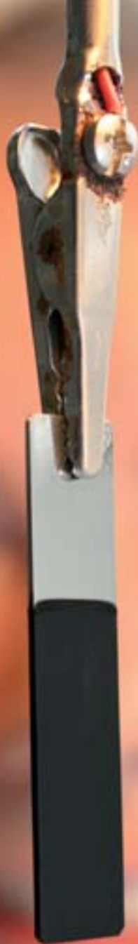
Figur 5. Rustfri stålelektrode (1.1 cm bred) med en 10 mikrometer polypyrrol aktuatorfilm efter syntese. Syntesen tager ca. ½ time. En aktuatorfilm frigjort fra elektroden ses på kapitlets indledende foto.
