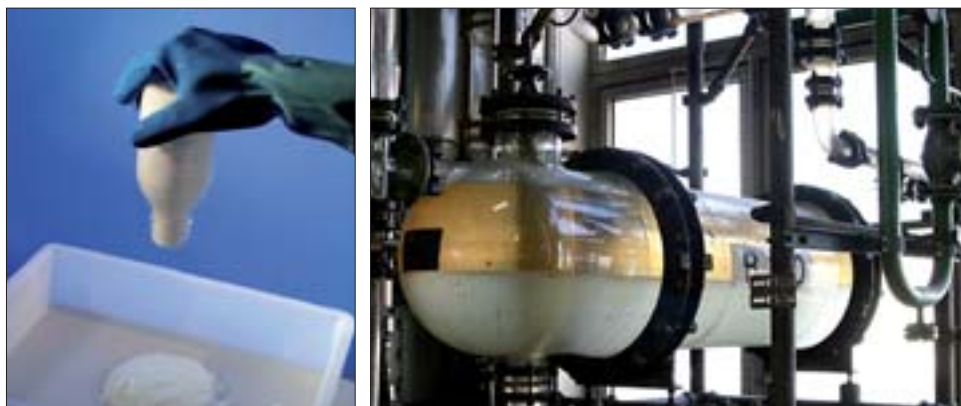
Figur 11. Ved BASF's BASIL™ proces fjernes uønsket saltsyre ved at omdanne det til den ioniske væske methylimidazoliumchlorid, som spontant faseadskiller fra det væskeformige fosforprodukt (højre). Ved processen som BASF tidligere brugte for samme reaktion, var det nødvendigt at fjerne store mængder af chloridsalt ved filtrering fra en grodet produktmasse (venstre). Fotos: Matthias Maase, BASF AG, Tyskland.
