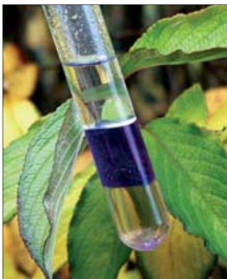
Figur 4. Et tre-fase system bestående af den farveløse ioniske væske 1-ethyl-3-methylimidazolium bis(trifluoromethylsulfonyl)imid, [EMIM](CF 3 SO 2 ) 2 N (nederst), vand indeholdende blåt farvestof (i midten) og en upolar organisk fase af nonan (øverst). De ellers blandbare faser af den ioniske væske og den organiske fase adskilles pga. deres ublandbarhed med vand og deres forskel i densitet, som er hhv. større og mindre end vands. Foto: Claus Hilgers. Copyright Solvent Innovation GmbH, Tyskland.
