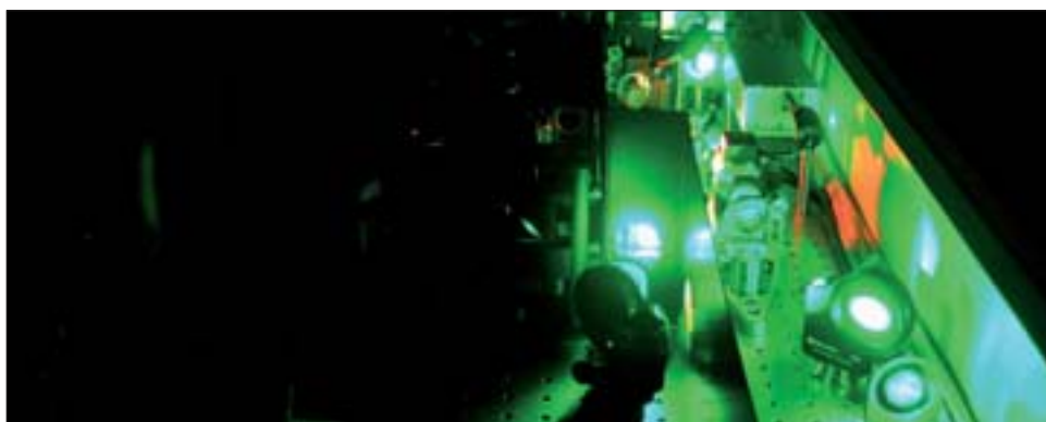
Figur 3. Billede af det indre af en laser, som kan skabe ultrakorte (femtosekund) pulser af lys. Betegnelsen laser er en forkortelse for: Light Amplification by Stimulated Emission of Radiation . Der skabes typisk 1000 pulser pr. sekund, så lyset synes at være tændt permanent, selvom det faktisk er slukket det meste af tiden. (Foto copyright Theis I. Sølling).
