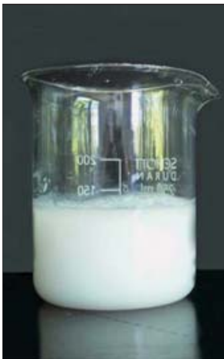
Figur 6. Syntesegel til fremstilling af zeolitter.
