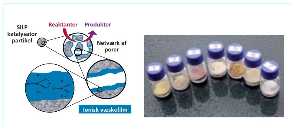
Figur 10. Skematisk opbygning af en supported ionic liquid-phase (SILP) katalysator, som indeholder opløste metalkomplekser i en ionisk væskefilm, der er fordelt på et bæremateriale (venstre). Forskellige SILP katalysatorer (højre). Foto: Marco Haumann (Universitat Erlangen-Nurnberg, Tyskland) og Anders Riisager.
