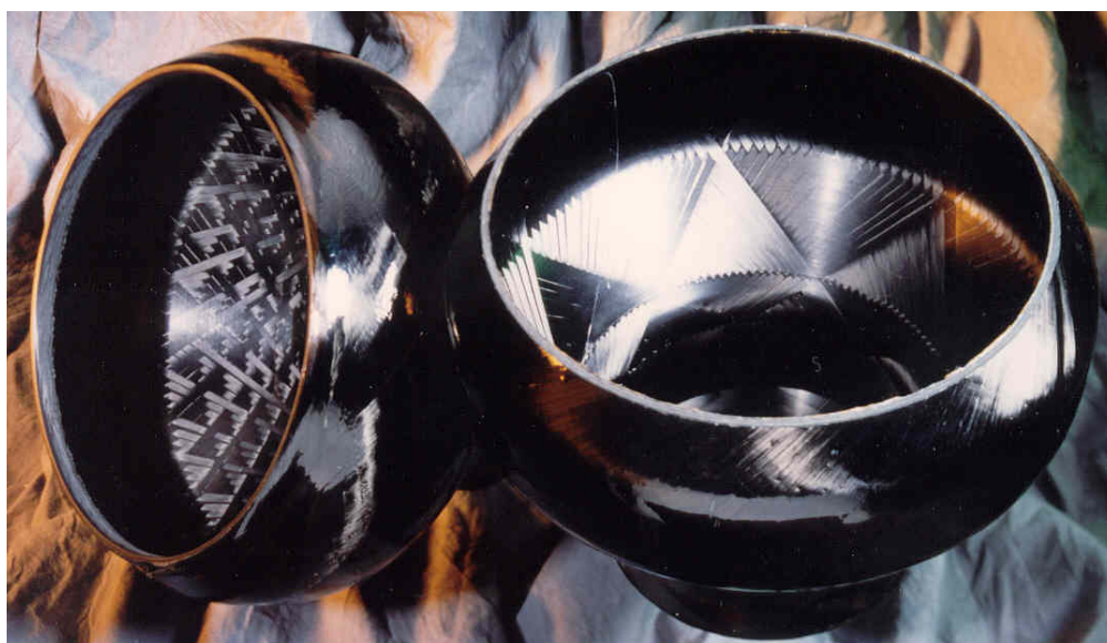
Figur 7. Illustration af forskellen mellem en 32-løbet (til venstre) og en 8-løbet vikling af det inderste lag i en kulfiber/epoxy-komponent (Foto: Boye Koch)
