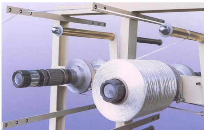
Figur 13. Passivt afspolesystem med aktiv trådspændingsregulering [22]
