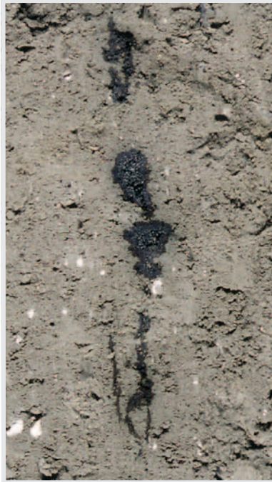
DNAPL i en subvertikal glacialtektonisk sprække i moræner. Foto stillet til rådighed af K. E. Klint, GEUS.
