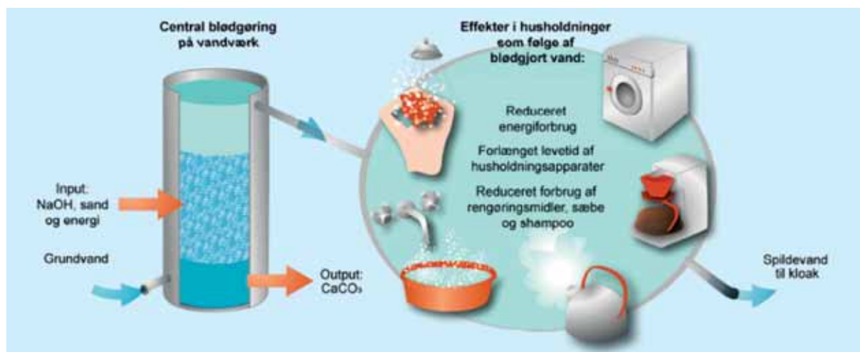
Figur 2: Oversigt over de konsekvenser på vandværket og i husholdningerne ved blødgøring af drikkevand, som er medtaget i livscyklusvurderingen.
