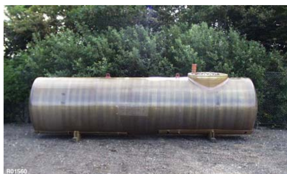
Fig. 3 Roug A/S fremstiller PERMATANKE, der er dobbeltvæggede tanke bestående af en ståltank inderst og en glasfiberbelægning yderst. Imellem stål og glasfiber er et lukket hulrum med vakuum. PERMATANKE fremstilles i 12 standardstørrelser fra 6 til 100 m 3
