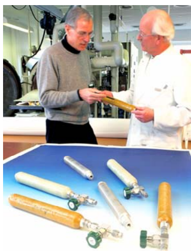
Fig. 2 Trykbeholdere i plastkomposit. Volumen: 400 ml. Designtryk: 25 MPa.
