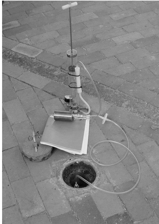
Figur 4. Spotmåling af radon i boring placeret i fortov. Bemærk scintillationscellen af messing og håndpumpen.
