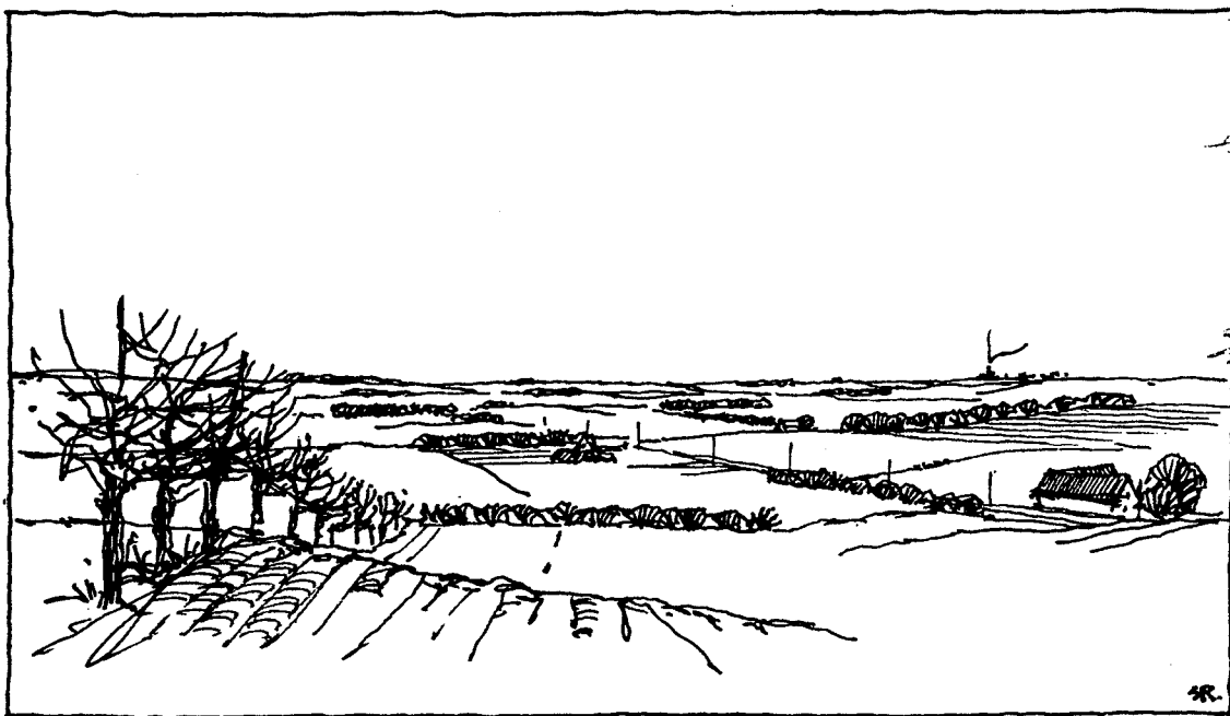
Figura 1.4. Esempio di terreno corrispondente alla classe di rugosità 2: zona di campagna con frangivento, separati tra loro mediamente di oltre 1000 m, con alcune aree edificate sparse ( z_0 = 0.10 m). Il territorio è caratterizzato da grandi aree libere in mezzo a molti frangivento, che mostrano un paesaggio aperto alla vista. Il terreno può essere piatto oppure ondulato. Vi sono molti alberi ed edifici.
