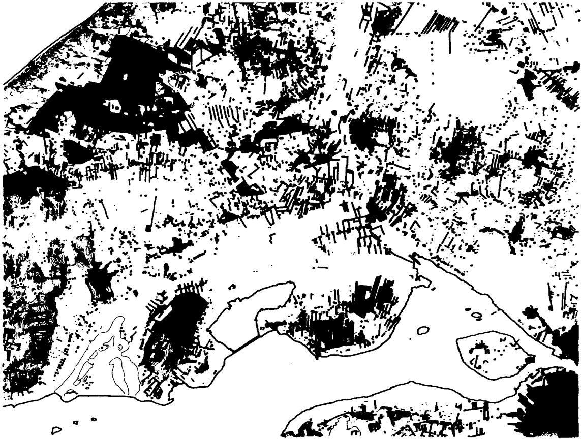
Figura 4.1. Ejemplo de mapa clasificado según valores de rugosidad en donde se han marcado los cinturones resguardantes, los grupos de árboles, granjas, pueblos, y plantaciones. El mapa cubre una área de aproximadamente 22 \times 28 km (Planstyrelsen, 1981).
