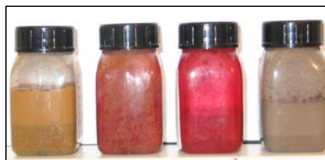
Sudan IV omrystningstest. Der ses tydelig påvisning af DNAPL (PCE) i de 2 midterste prøver, i de andre er ingen reaktion. Billede stillet til rådighed af Orbicon.
