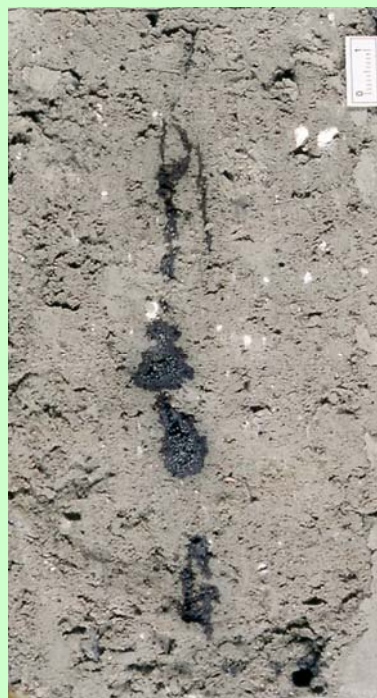
Foto fra tidligere gasværksgrund, som viser tjære, der siver fra en sub-vertikal glacialtektonisk sprække i moræneler. Skala 1 cm, dvs. foto ca. 7 cm x 13 cm. Foto stillet til rådighed af K. E. Klint, GEUS.
