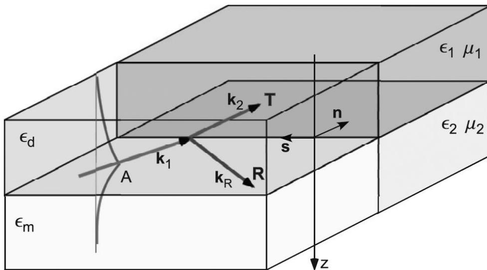
Рис. 1. Геометрия задачи: поверхностный поляритон возбужден на между металлом  $\epsilon_m$  и диэлектриком  $\epsilon_d$  и распространяется с волновым вектором  $\mathbf{k}_1$ . На границе с другими двумя средами поверхностная волна частично отражается (с волновым вектором  $\mathbf{k}_R$ ) и преломляется с волновым вектором  $\mathbf{k}_2$
