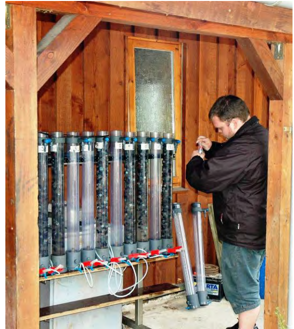
Figur 4.8. Biofiltersektioner fra model 3-dambrug, og nedenfor forsøgsopstilling med biofilterelementer udsat for forskellig behandling. I hvert delforsøg med samme mængde biofilter-elementer tilsættes en kendt mængde \text{NH}_4\text{Cl} eller \text{NaNO}_2 og der udtages vandprøver over tid til senere analyser. [Foto: LFP]
