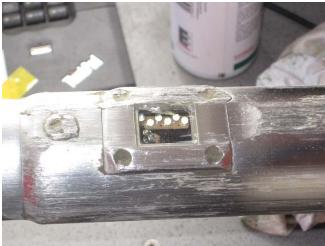
Figur 9 VCPT sondens vindue efter kontakt med sten. De ses en medrivning af det rustfrie stål langs modsatte side af vinduet
