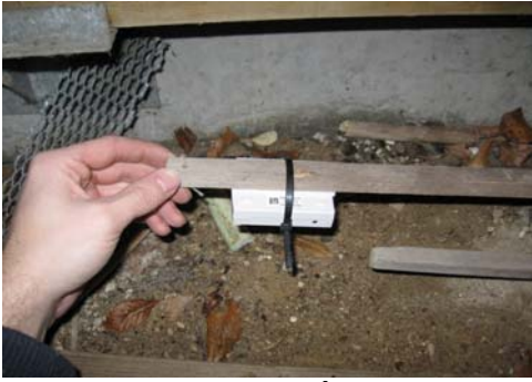
Figur 94 HOBO monteres på pind.
