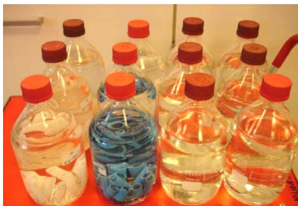
Figur 28: Forsøgsopsætning: 2 L flasker med drikkevand fra Lyngby Vandværk med PE, PEX og silicone inokuleret med K. pneumoniae og E. coli og 2 L flasker med drikkevand fra Lyngby Vandværk kun inokuleret med K. pneumoniae og E. coli (kontrolflasker). Inkuberet ved 15 °C.
