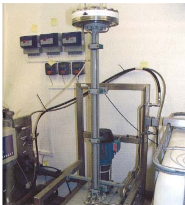
Figur 18 testanlæg til genanvendelse af næringsstoffer fra det sorte spildevand
