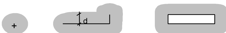
Figur 14. Eksempler på buffere omkring et punkt, linie og polygon. Bufferafstanden er d [Rehfeld, C. (1994)]
