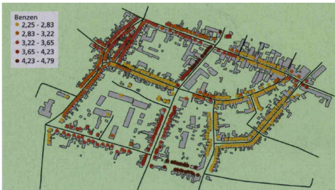
Figur 32. Eksempel på fordelingen af Benzen i Middelfart. Kortet viser årsniveauet for benzen beregnet på de enkelte adresser i et udsnit af det centrale Middelfart [Solvang Jensen, S. (1998)].
