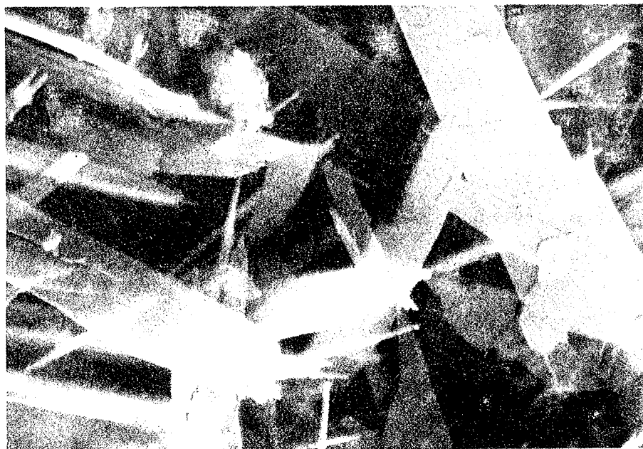
Fig. 3.10. SEM-billede, forstørrelse ca. 9000 x. Samme område som foto 3.9. Tobermoritens pladestruktur ses. Pladeenderne er spaltet på grund af, at prøven har været udtørret ved 105°C.
