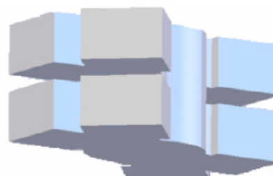
Figura 3: El diseño de imán por Zimm et al. (2007). De Chell (2009). La alta densidad de flujo se genera en el hueco entre las dos estructuras en forma de “Y”. La dirección de la magnetización para los imanes individuales es demasiado compleja para mostrarla en la figura.
