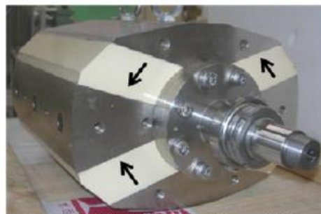
Figura 4: El diseño de imán por Okamura (2009). Las flechas muestran la dirección de la magnetización de los imanes (en blanco). No se muestra el yugo exterior.
