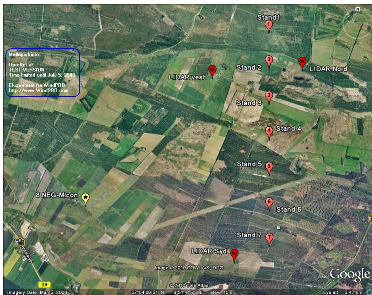
Figur 8 Google Earth image af de 3 lidar målepositioner og møllerækken med de 7 møllestande.
