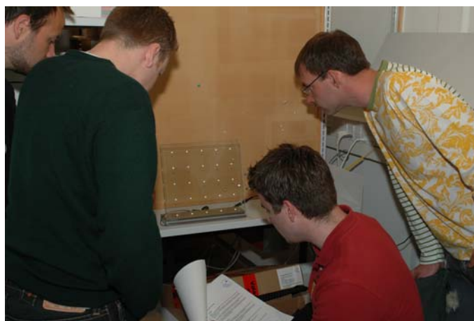
Figur 16 Aktivitet i Risø's LED laboratorium ved en af kursets workshops hvor designerne havde mulighed for selv at udføre målinger på spektralfordeling, farvetemperatur og udstrålingsfordeling.
