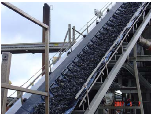
Tegning 4.1. Der udtages prøver to steder i opsorteringen af muslingelandingerne på de virksomheder der indgår i undersøgelsen. Fotos 1: transportør som løfter fangsten til sorteringstrømle der vises på fotos 2.
