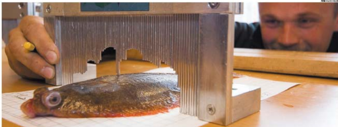
Med hjælp af en række målepinde, som forsigtigt presses ind til de har kontakt til fisken, afferades et aftryk af fiskens form. Aftrykket bliver efterfølgende scannet ind i en computer til videre billedbehandling. Målet er at skabe nye fiskegam, der nedsætter bifangster og beskytter fiskbestandene.
