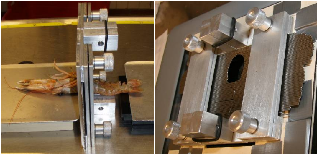
Fig. 29. Eksempel på opmåling af tværsnitskontur for jomfruhummer.
