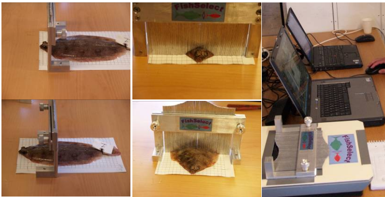
Fig. 22. Opmåling og scanning af tværsnitkonturer for rødtunge.
