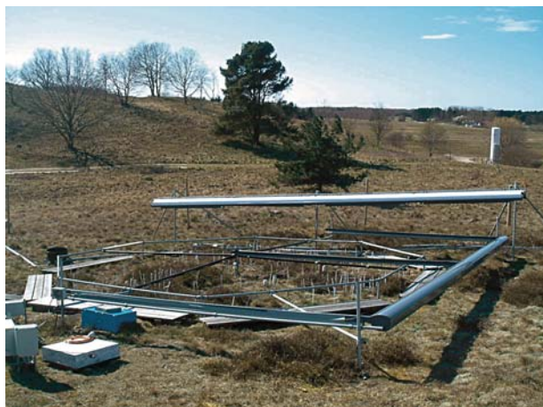
Figur 2. CLIMAITE-forsøget ligger på Brandbjerg ved Jægerspris. Her udsættes en hede for et klimascenarie, som det forventes i Danmark anno 2075 med samtidige forhøjelser af CO 2 -koncentration, temperatur og forlængt sommertørke. Manipulationerne startede i 2004.
