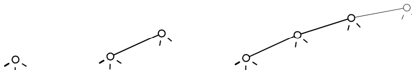
Figur 16. Princippet i en successivt opbygget dobbeltunderstøttet randstringer.
