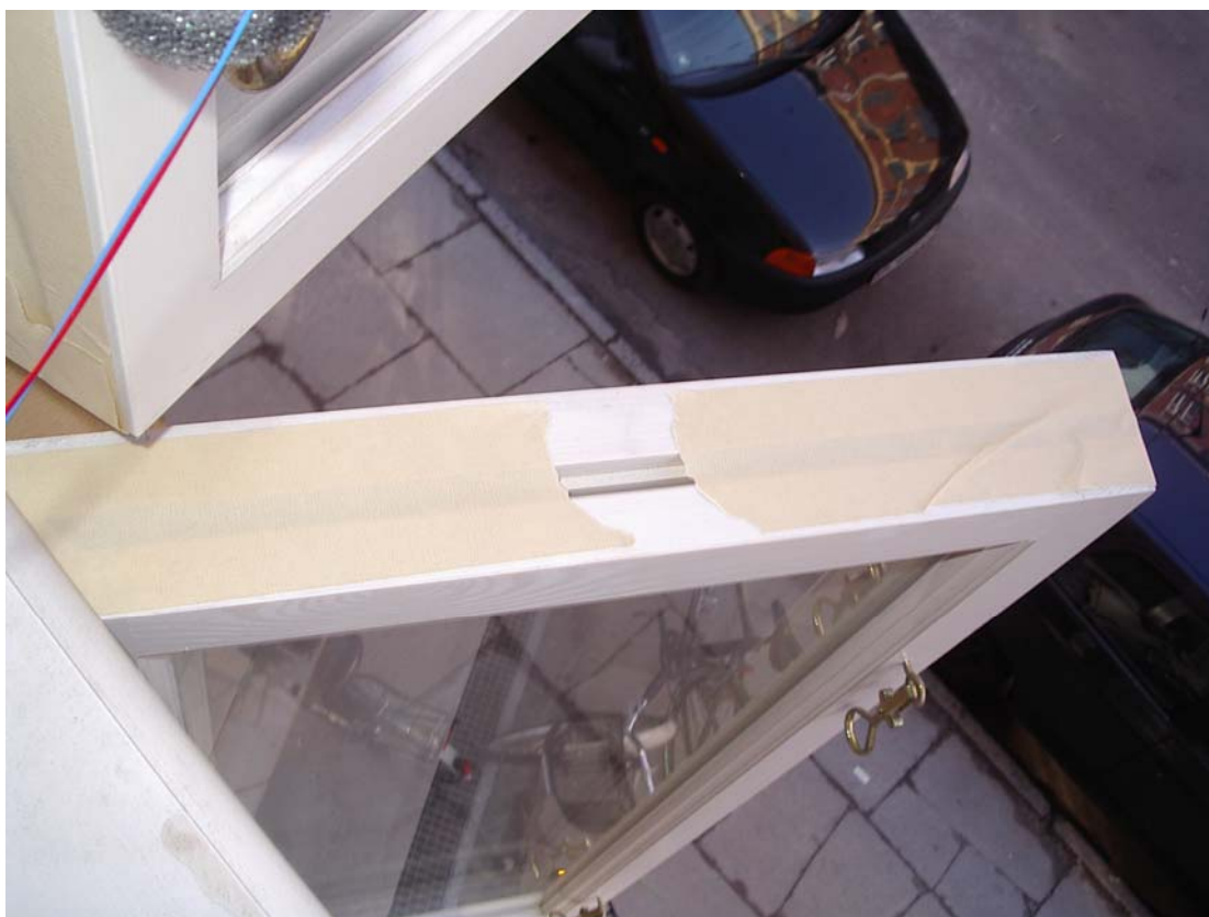
Figur 17. Spalten mellem vinduesramme og den koblede ramme blev ved en måling lukket med tape på nær ca. 2 cm i top og bund.
