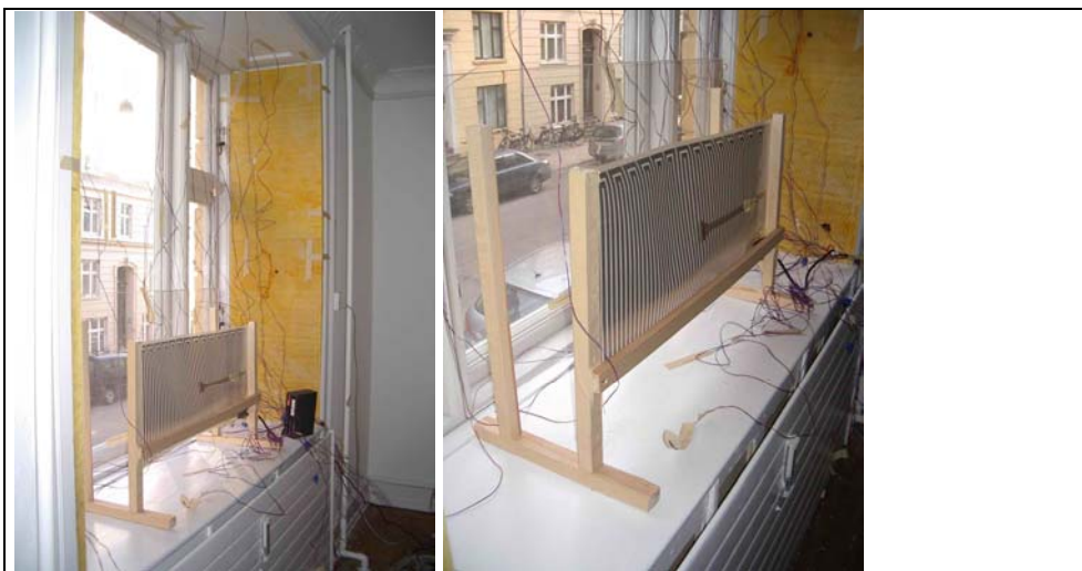
Figur 15. Varmefolien placeret i mellem vindue og isoleringsplade samt diverse temperatur målinger.
