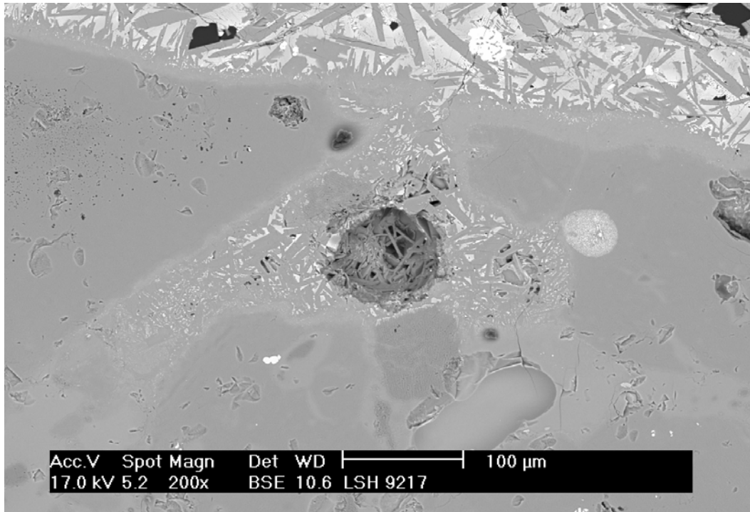
Figur 5. Fra prøven: "Afbreaket klinke". Dybereliggende pore i anden overgangszone (Zone C). Den lyse lamellerede zone tæt omkring poremundingen er af typen "første overgangszone" (Zone A), som er rig på calcium.
