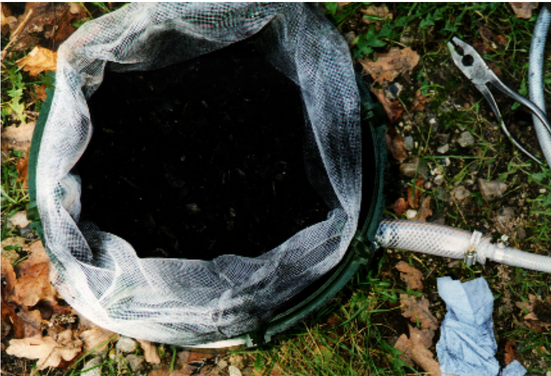
Figur 4.1 Aktivt kulfilter set fra oven fyldt med aktivt kul fra 100 kW forgasseren.
