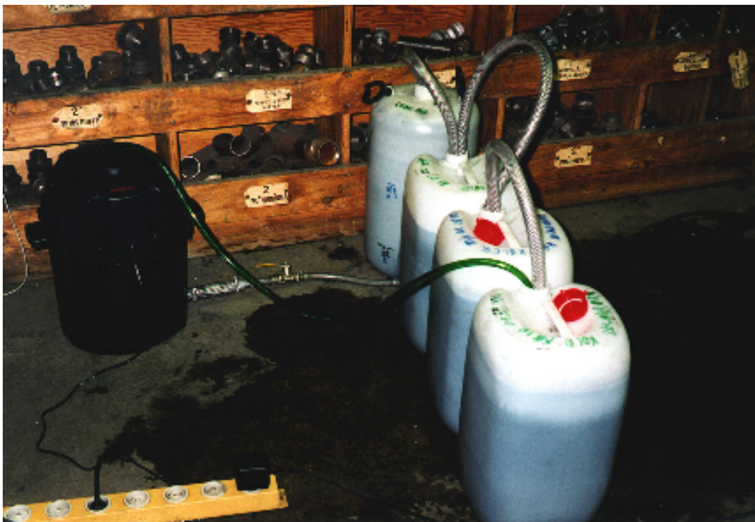
Figur 4.2 Aktivt kulfilter (til venstre) under drift. 4 dunke med kondensat renses i serie ved benyttelse af hævertprincippet.
