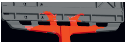
Obr. 4. Nerovnoměrný tok taveniny do dutiny formy
